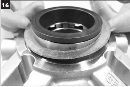
16 Contayı adaptörden çıkarın ve atın.
